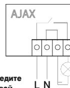
При установке устройства в подрозетник, выведите антенну наружу и разместите под пластиковой рамкой розетки. Чем дальше антенна будет расположена от металлических конструкций, тем меньше шанс экранирования радиосигнала. Ни в коем случае не укорачивайте антенну.
